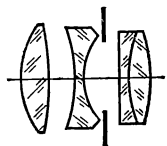
Рис. IV, 8. Оптическая схема объектива «Тессар»
